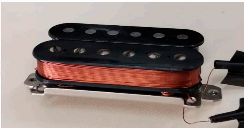
Figura 3. Bobina inicial feita para os testes.
