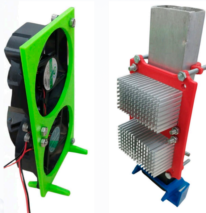
Figura 2: Suporte com fans dissipadores e protótipo montado
